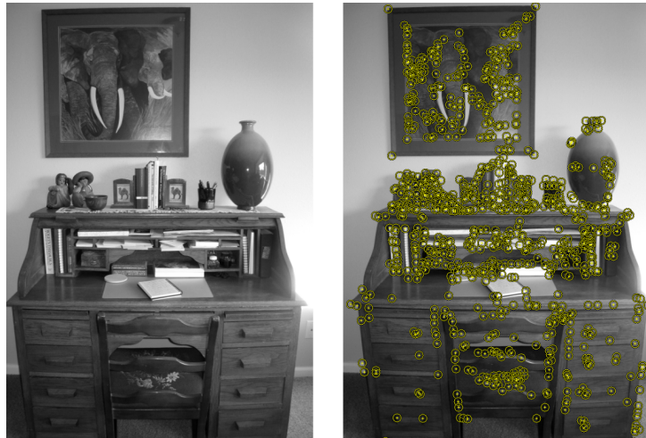
Figura 8 – Exemplo de detecção de features pelo algoritmo Harris Corner Features .
