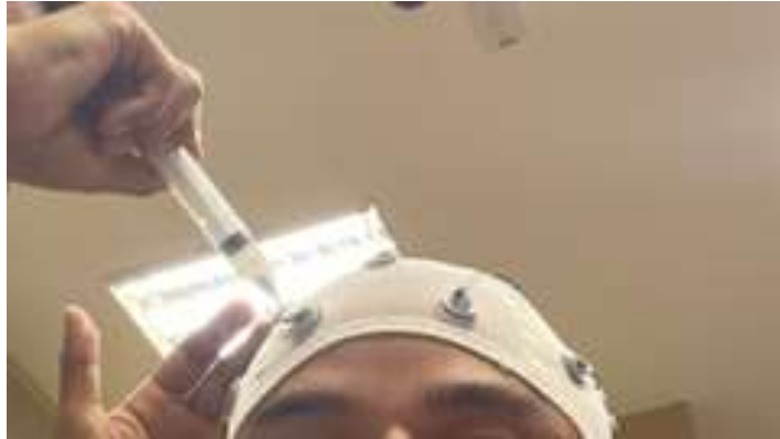
Figura 21- Posicionamento da touca de eletrodos, parte do hardware OpenBCI.
