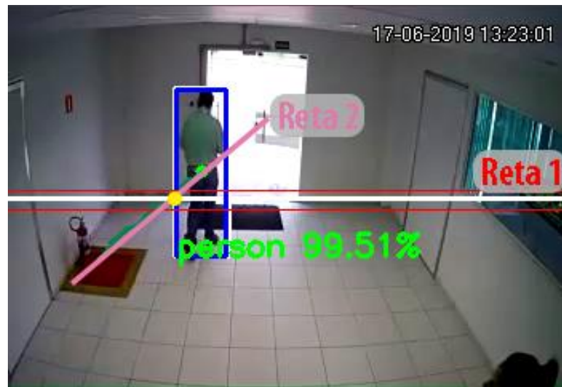
Figura 12 – Retas utilizadas para verificação de intersecção para detecção de entrada ou saída
