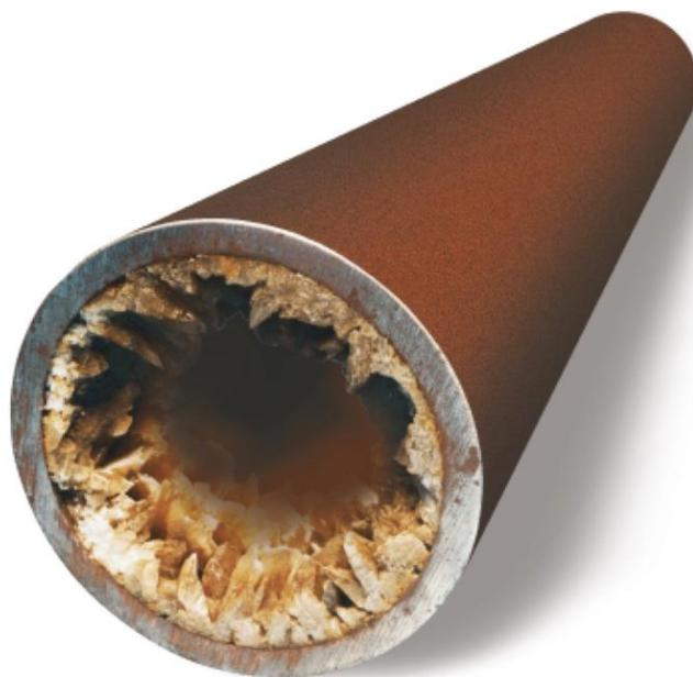
Figura 1 – Incrustação de carbonato de cálcio em tubulação (CRABTREE et al., 1999)
