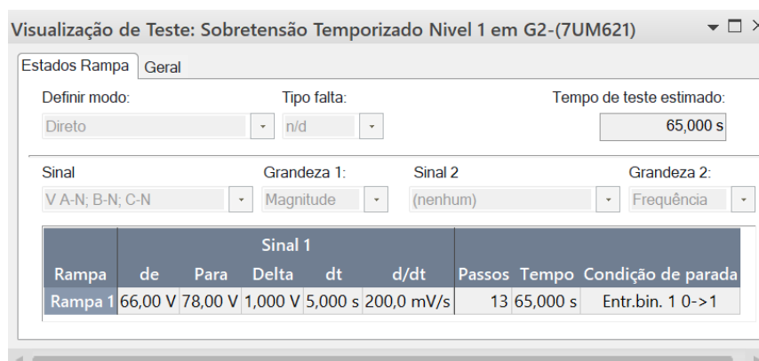
Figura 3 - Configuração rampa de sobretensão
