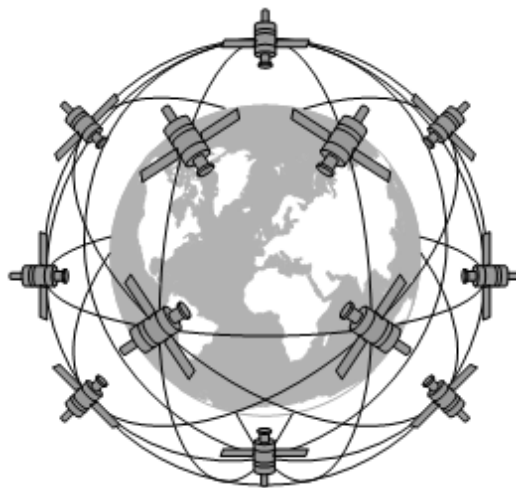
Figura 2 - Disposição dos satélites GPS em órbitas
