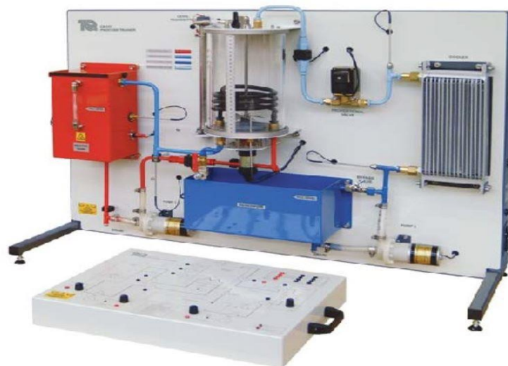
Figura 1 - O hardware do kit didático CE117: o módulo de experimentos e o módulo de controle.
