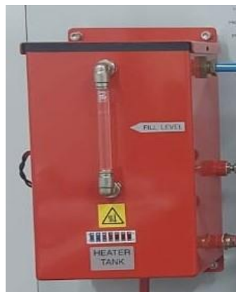
Figura 16 - Tanque de aquecimento
