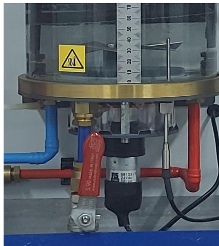
Figura 11 - Válvula de dreno (à esquerda), misturador giratório (centro) e medidor de temperatura (à direita)
