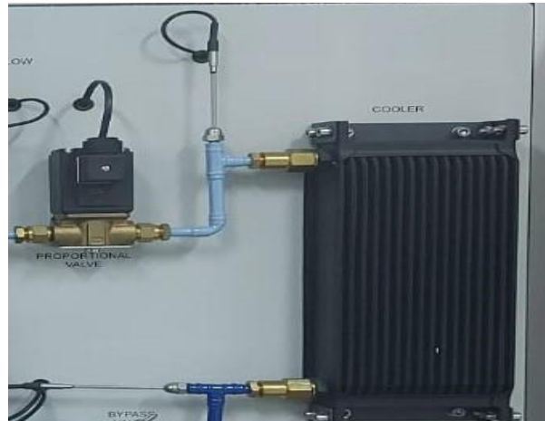
Figura 13 – Radiador e sensores de temperatura com resistência de platina, com válvula proporcional à esquerda
